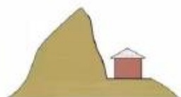
削山建房应进行护坡处理
